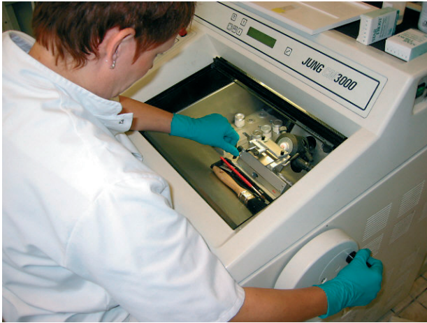
Het snijden van een coupe van een diepgevroren weefselstukje in een vriesmicrotoom bij -20^{\circ}\text{C} .
